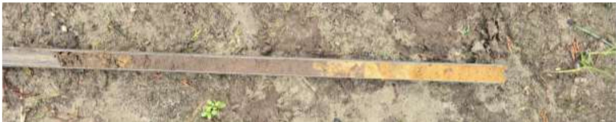
Figuur 25: Foto van boring 5 met de kenmerkende bodemopbouw binnen het plangebied met links de bouwvoor van overwegend humusrijk zand, rechts van het midden de door ijzervlekken gekenmerkte Cg-horizont en geheel rechts de C-horizont. In deze boring is de top van de Cg-horizont verploegd.
