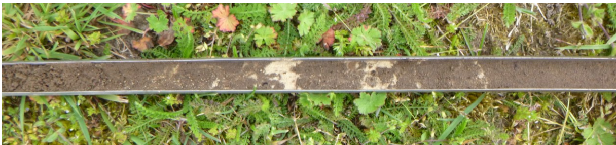
Figuur 23: Foto van het rommelige pakket humusrijk zand met daarin brokken schoon zand zoals dit bovenin acht van de negen boringen is aangetroffen
