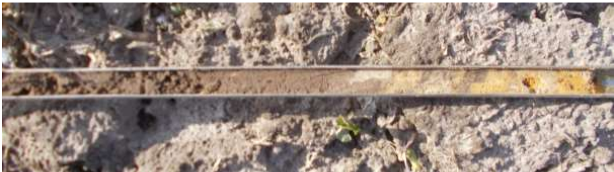
Figuur 17: Foto van het sterk geroerde zandpakket (rechts) zoals dat op alle boorpunten onder de bouwvoor (links) is aangetroffen.
