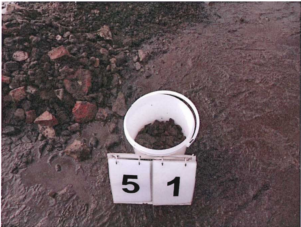
foto 4: uitkomende materiaal inspectiesleuf S1 (traject 0-0,3 m-mv, 8 februari 2013)
