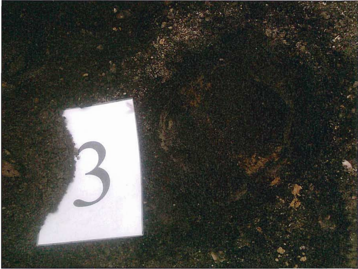
Foto 7: Uitkomend materiaal inspectiegat 3 gebroken puin- en asfaltverharding (7 januari 2013)
