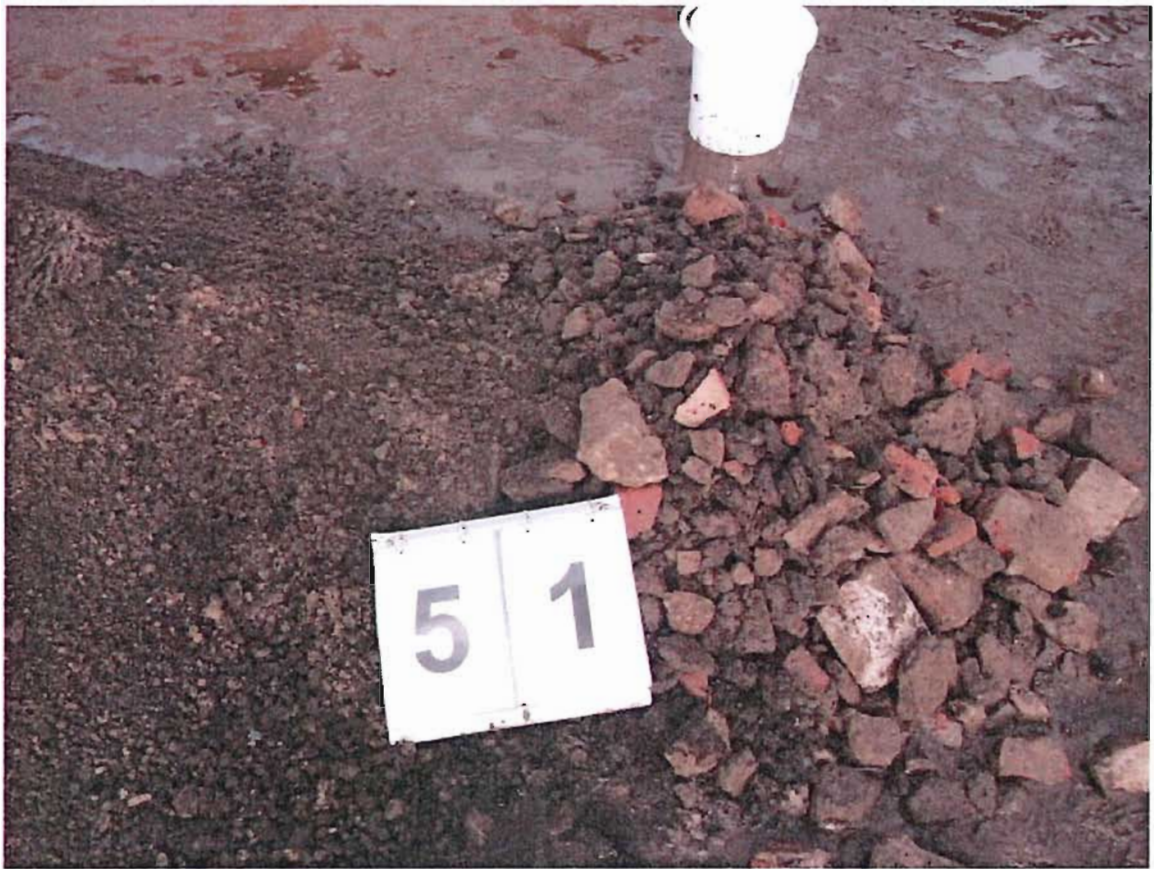
foto 3: uitkomende materiaal inspectiesleuf S1 (traject 0-0,3 m-mv, 8 februari 2013)
