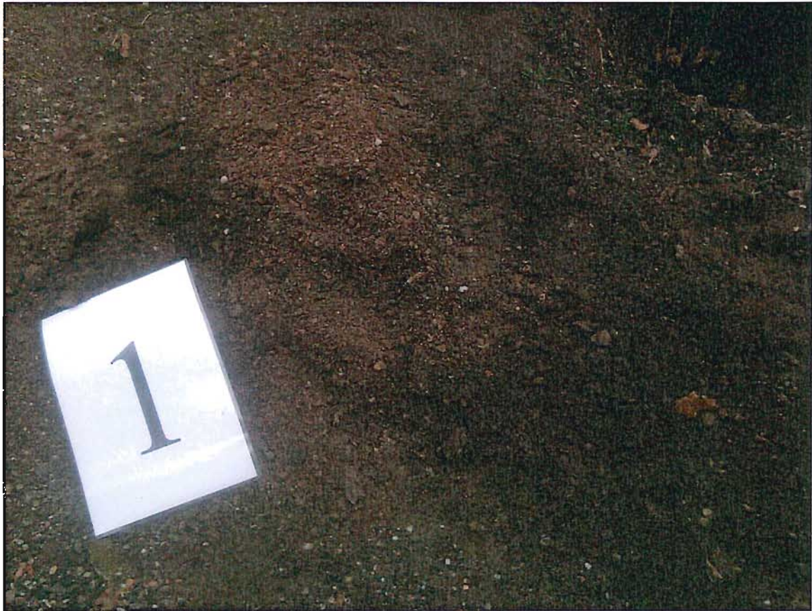
Foto 5: Uitsluitend materiaal inspectiegat 1 gebroken puin- en asfaltverharding (7 januari 2013)
