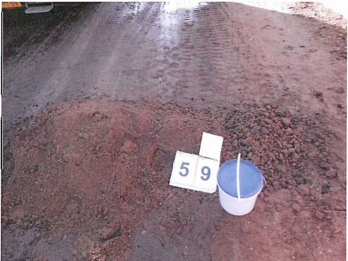
foto 14: uitkomende materiaal inspectiesleuf S9 (traject 0-0,2 m-mv, 8 februari 2013)
