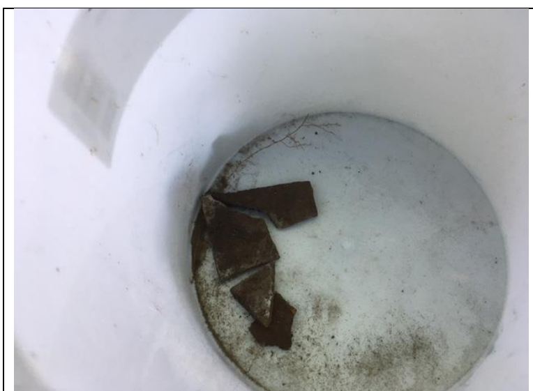
Foto 3: uitkomend asbestverdacht materiaal proefsleuf 30 (14 mei 2019)
