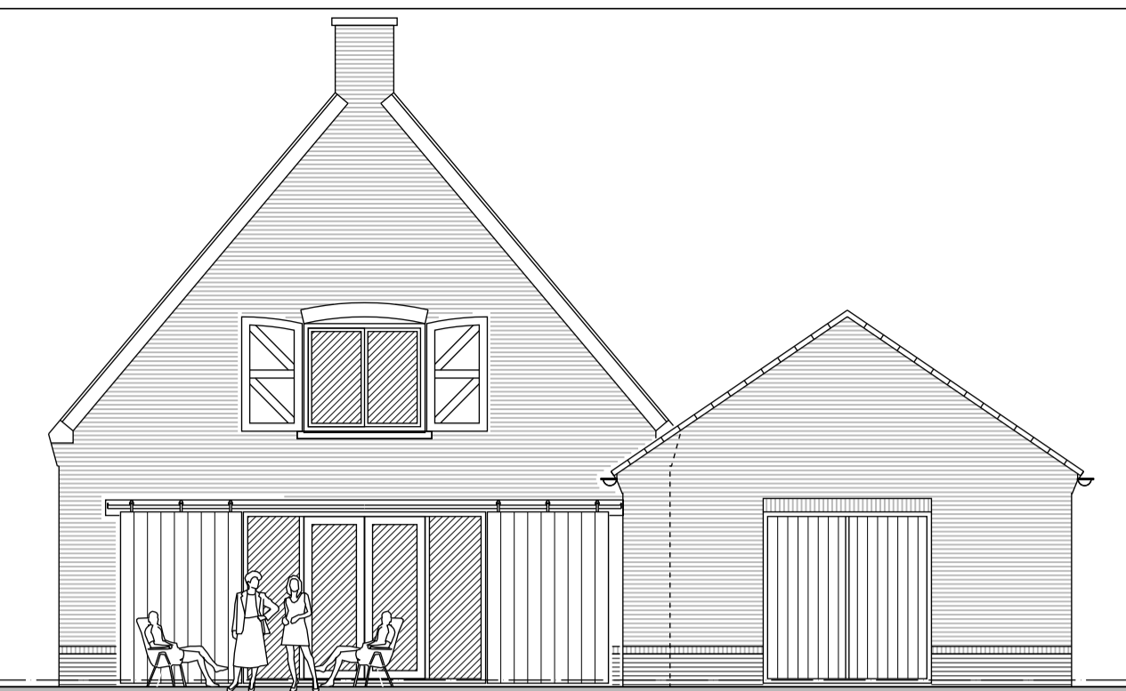
Achtergevel kozijnen / deuren / ramen antraciet schuifdeuren / luiken donker groen
