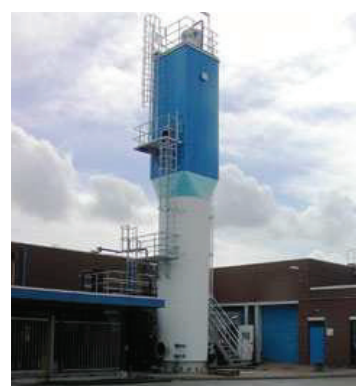
Figuur 1. Het Sharon-Anammox proces. De Sharon-reactor is een chemostat en de Anammox-reactor is een SBR. Het proces wordt uitgevoerd in twee opeenvolgende reactoren. In de eerste reactor wordt ammoniak gedeeltelijk geoxideerd tot nitriet. In de tweede reactor wordt het nitriet geoxideerd tot nitraat.
