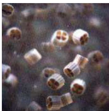
Figur 12 left KMB carrier (Kaldnes Miljøteknologi AS), right process configurations (STOWA, 2006)
