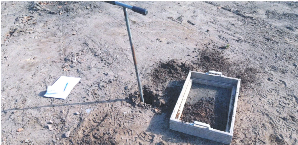
Figuur 22: Het naboren met een edelmanboor en het zeven van het hiermee opgeboorde zand.
