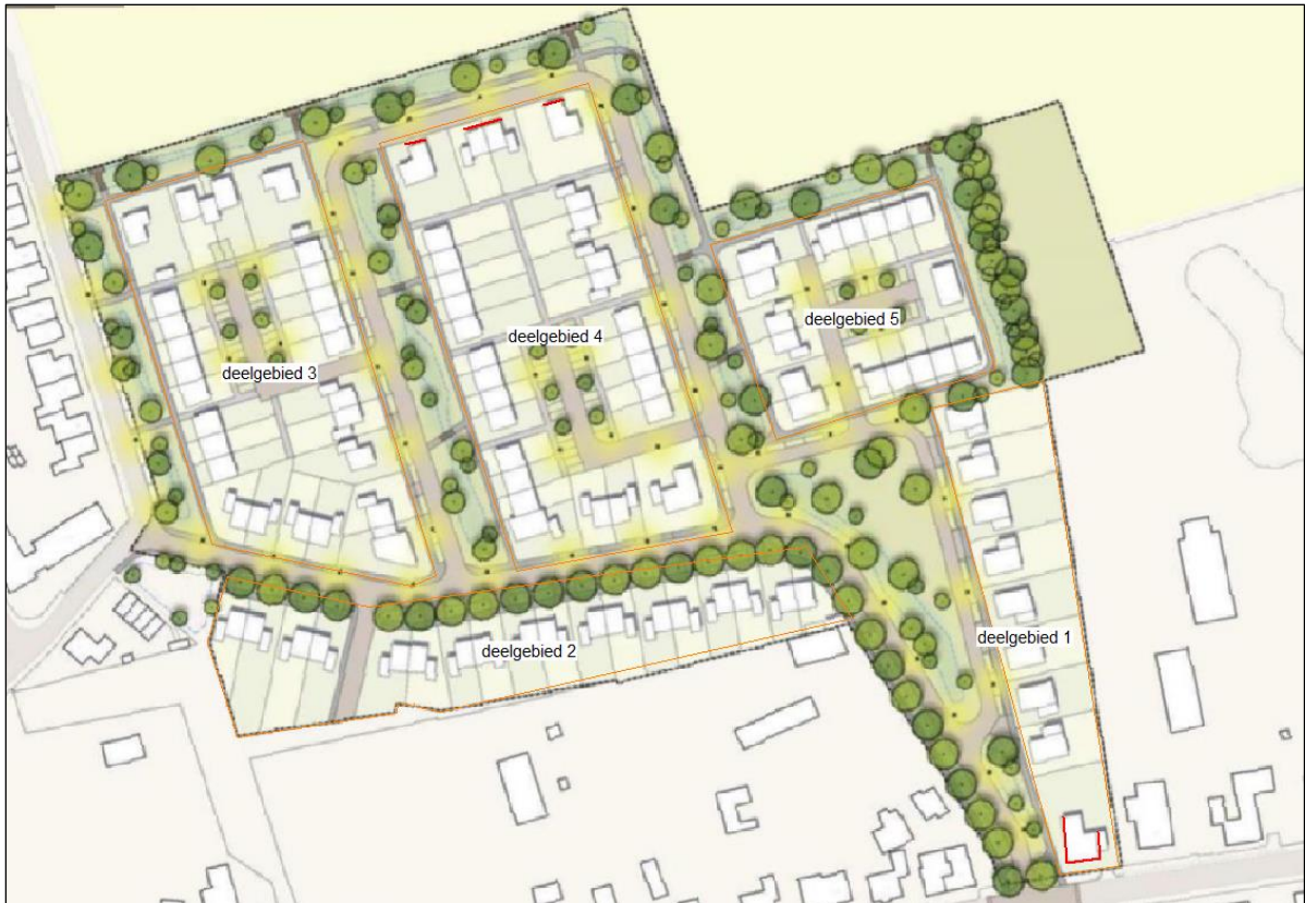
Figuur 4.1 Deelgebieden en gevels met overschrijdingen van de ten hoogst toelaatbare geluidbelasting (rood)
