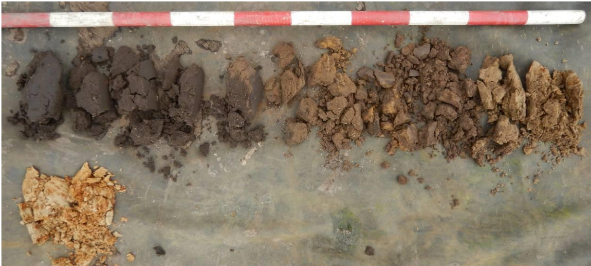
Figuur 26: Foto van boring 5, uitgelegd van links naar rechts per meter
