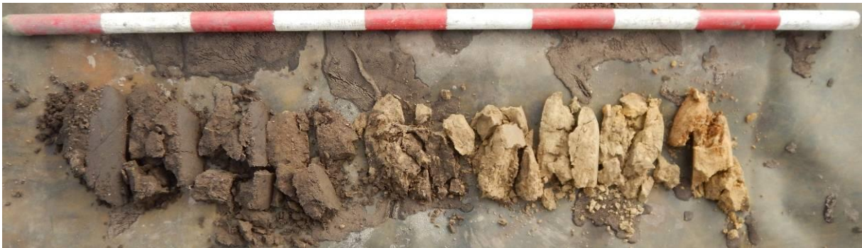
Figuur 27: Foto van boring 8, uitgelegd van links naar rechts per meter
