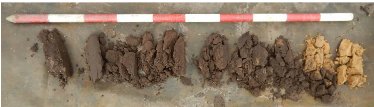
Figuur 25: Foto van boring 4, uitgelegd van links naar rechts per meter
