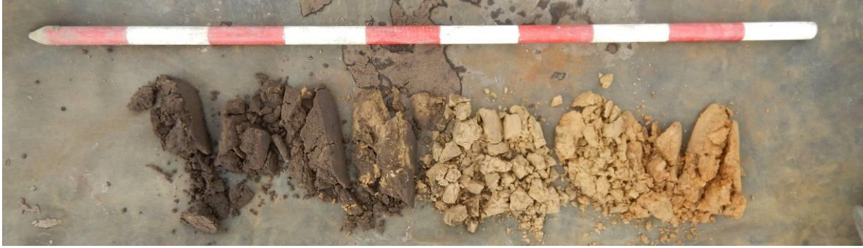
Figuur 23: Foto van boring 2, uitgelegd van links naar rechts per meter
