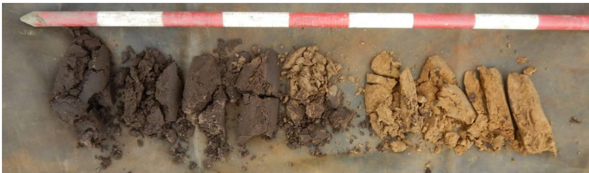
Figuur 22: Foto van boring 1 , uitgelegd van links naar rechts per meter
