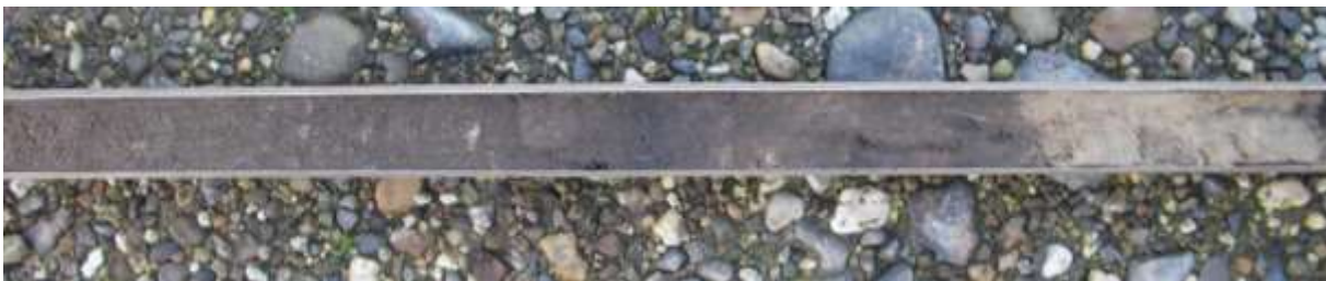
Figuur 16: Foto van boring 20 met in het midden venig zand met links de rommelige toplaag en rechts het sterk lemig zand.
