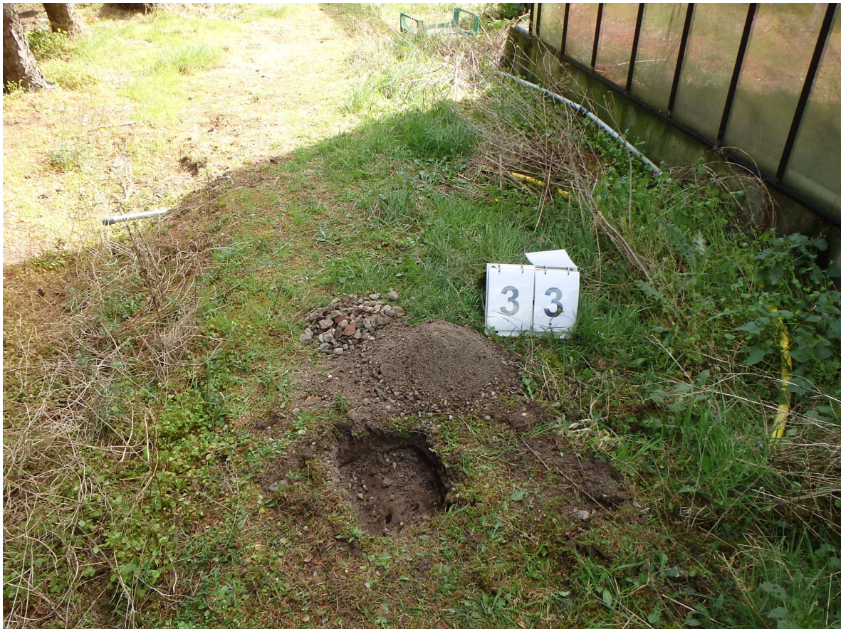
Foto 18: Inspectiegat IG33 puinverharding met uitkomend gezeefd materiaal (9 april 2014)
