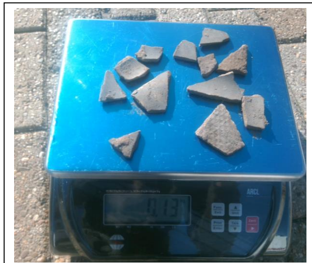
Foto 2. Aangetroffen asbestverdacht (plaat)materiaal uit gat C101
