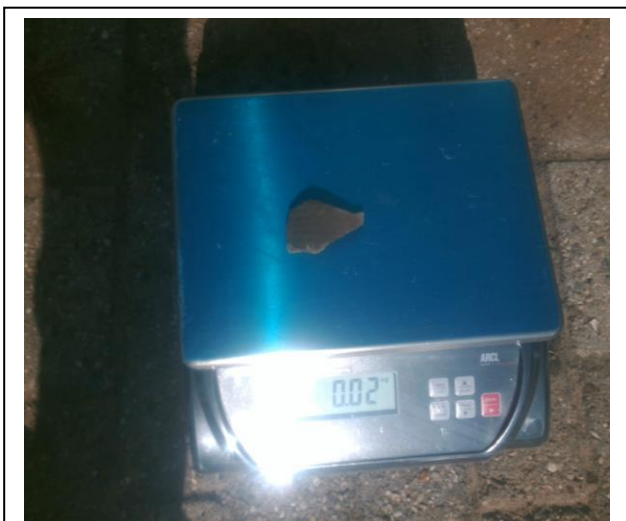
Foto 5. Aangetroffen asbestverdacht (plaat)materiaal uit gat C103
