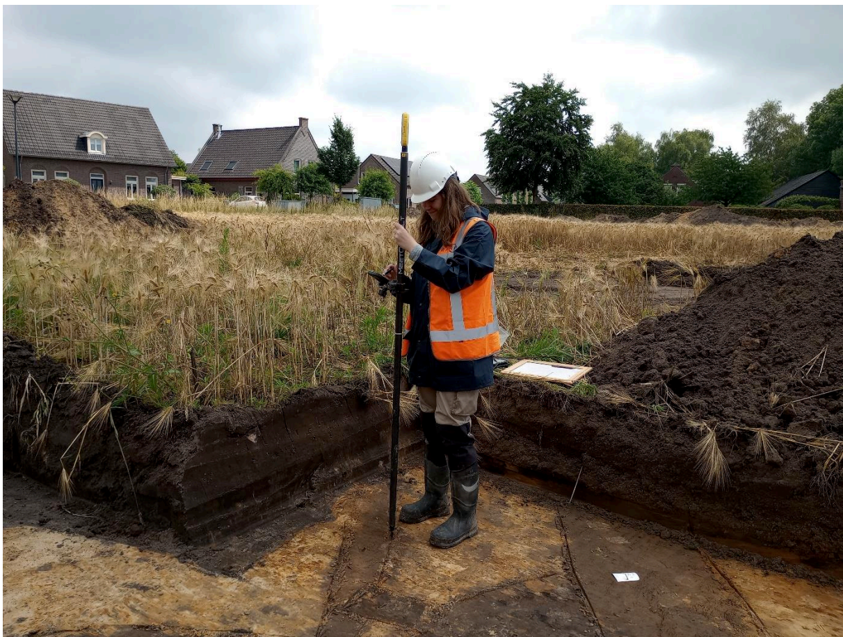
Figuur 4. Het inmeten van de grondsporen met een RTK-GPS bij spoor 12.
