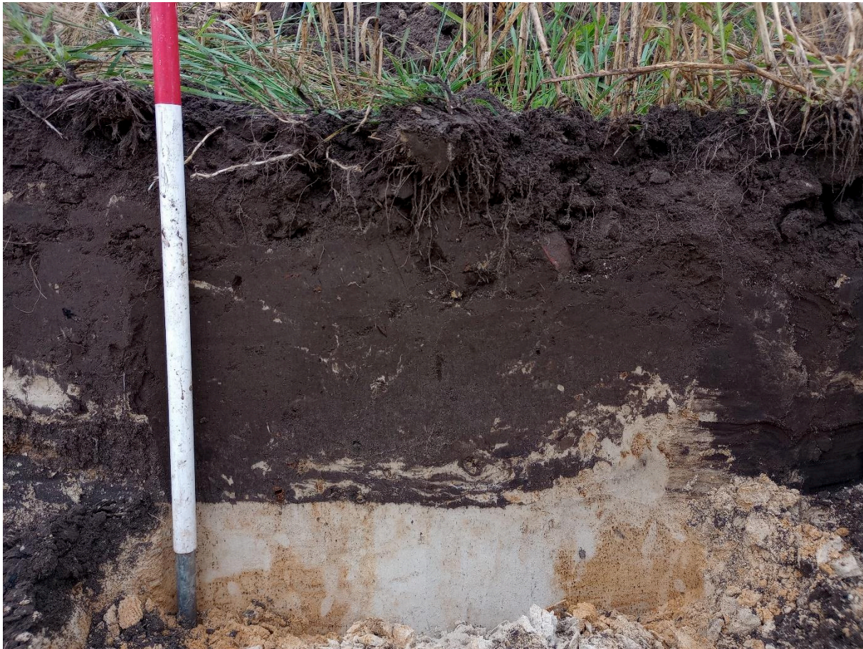
Figuur 5. Profiel 341, waaruit duidelijk blijkt dat er sprake is van een AC-profiel.
