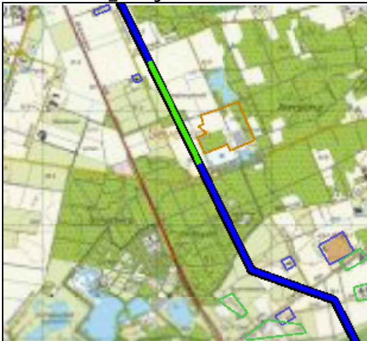
Figuur 4.2 Kilometer leiding behorende bij de maximale overschrijding van de FN-curve voor 2203_leiding-A-520-deel-1
