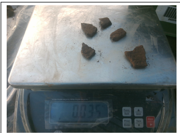
Foto 11. Asbestverdacht plaatmateriaal gat 10
