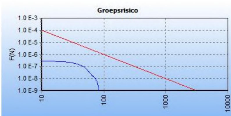
5.4 Figuur 5.4 FN curve voor A-520 met SBW 370 m en 250 m + 20cm oph van N.V. Nederlandse Gasunie voor de kilometer tussen stationing 2490.00 en stationing 3490.00
