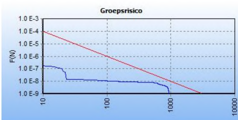
5.4 Figuur 5.4 FN curve voor A-520 met SBW 370 m en 250 m + 20cm oph van N.V. Nederlandse Gasunie voor de kilometer tussen stationing 2340.00 en stationing 3340.00
