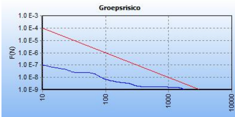
5.3 Figuur 5.3 FN curve voor 4629_leiding-A-665-deel-1 van N.V. Nederlandse Gasunie voor de kilometer tussen stationing 3050.00 en stationing 4050.00
