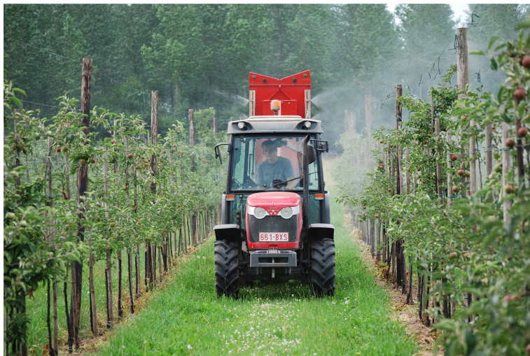
Figuur 3.2: Voorbeeld dwarsstroomspuit fruitbomen (rechts normale spuitdoppen, links 75% driftreductie)
