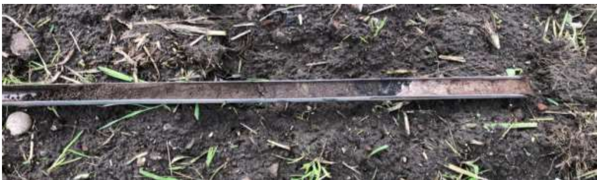
Figuur 22: Foto van boring 7 met links de bouwvoor, rechts van het midden de moerige zandlaag en geheel rechts de doorwortelde top van het dekzand die is gevormd in de beginperiode van de veengroei.
