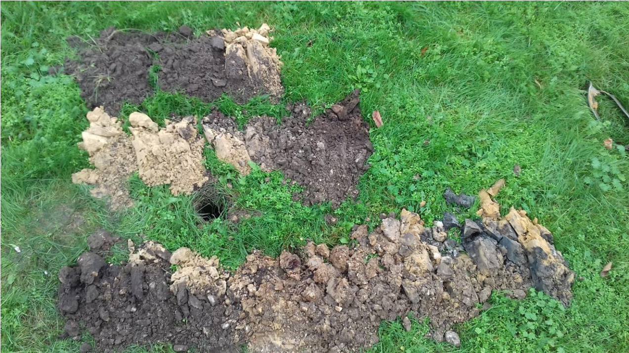
Figuur 4: boring 3 met duidelijke restanten van opgebrachte en verrommelde lagen. Daarnaast rechtsonder de blauwgrijze reductie laag (leesrichting is van linksboven naar rechtsonder).
