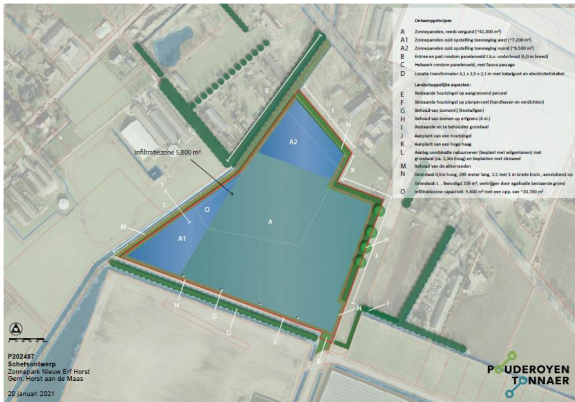
Figuur 6 Schematische weergave landschapsplan met infiltratiezone
