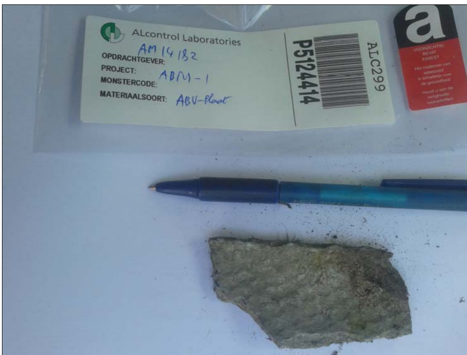
Afbeelding 2: asbestverdacht materiaal nabij schuur
