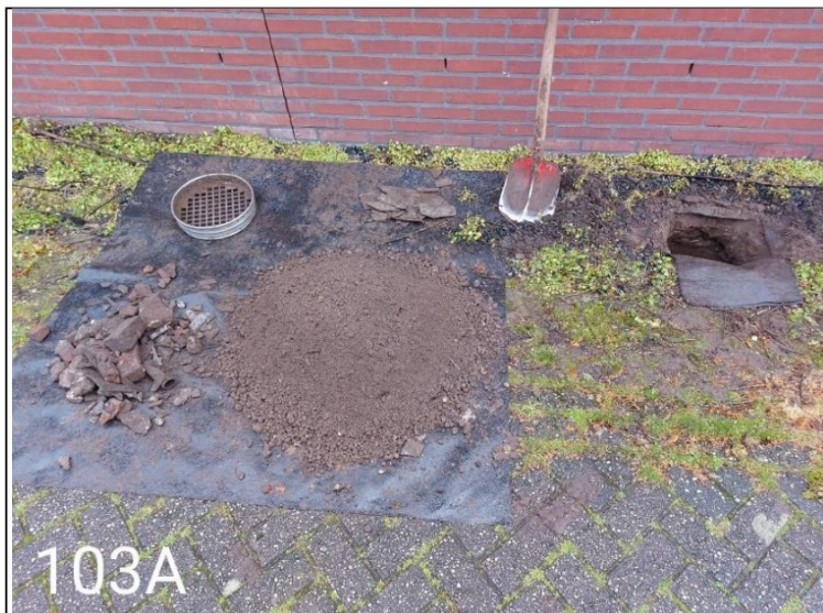
Foto 5: uitkomend materiaal proefgat 103A
