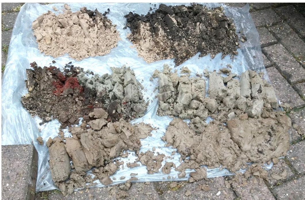
Afbeelding 3: Foto boorprofiel boring 2, leesrichting van linksboven naar rechtsonder
