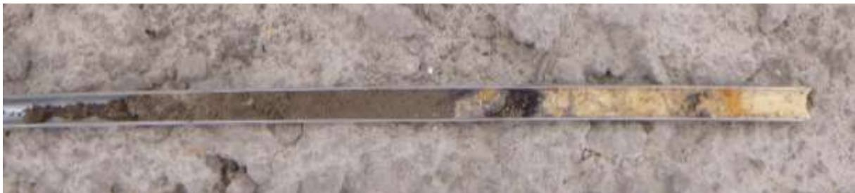
Figuur 24: De menglaag met brokken moerig zand zoals deze in de boringen 13, 28 en 34 is aangetroffen (rechts van het midden).
