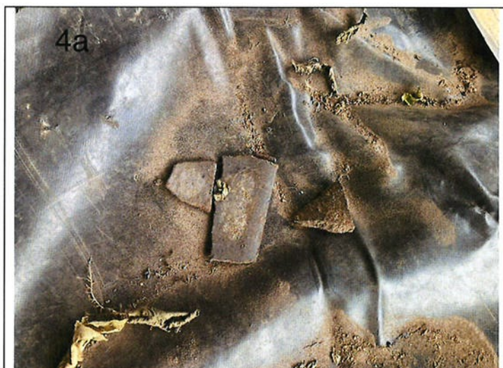
Foto 2: asbesthoudend materiaal proefsleuf C4a
