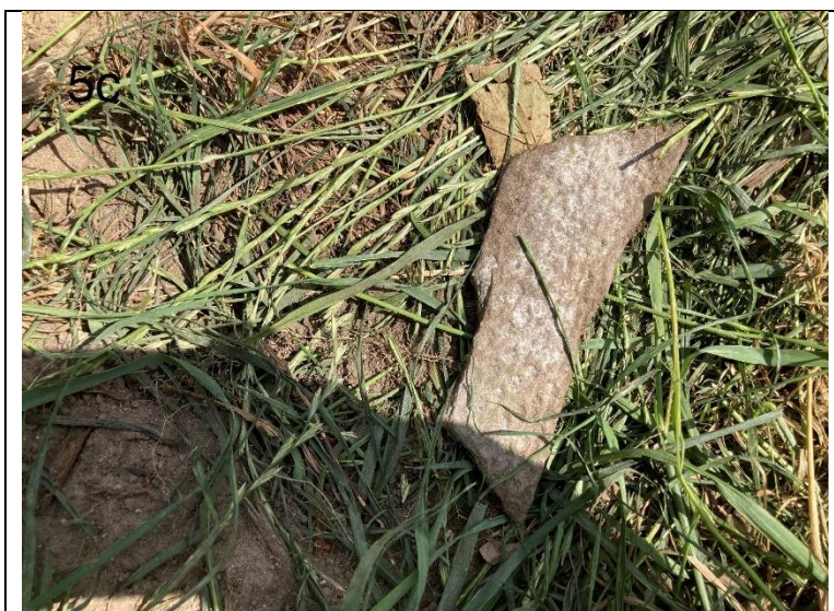
Foto 11: asbesthoudend materiaal proefsleuf C5c
