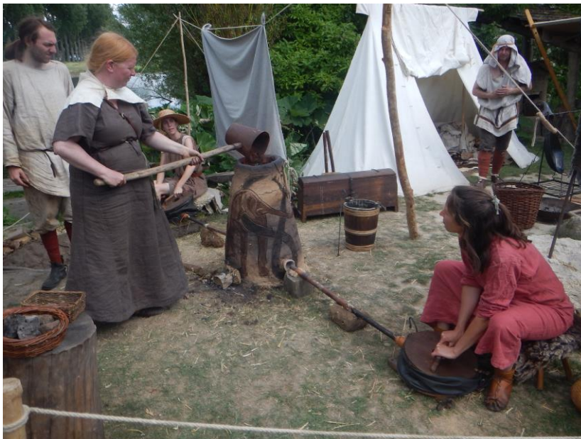
Figuur 17. Productie van ijzer uit ijzeroer op middeleeuwse wijze in het Prehistorisch dorp in Eindhoven (d.d. 4 juni 2017).
