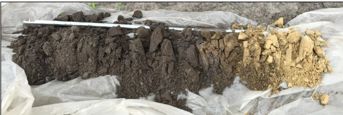
Figuur 6: Zicht op boring 13, de leesrichting is van links naar rechts (0-120 cm-mv).
