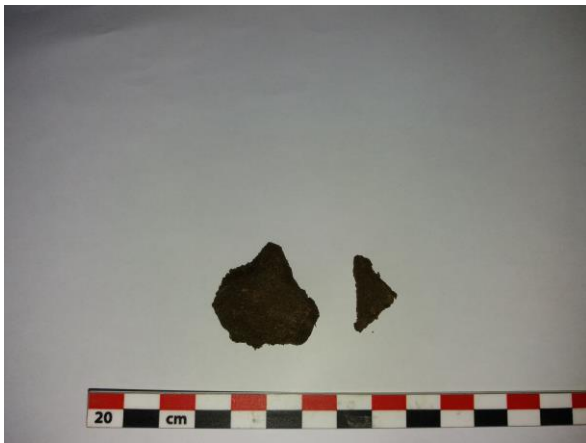
Foto asbestverdacht materiaal ABG8
