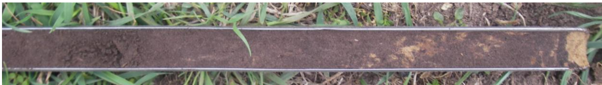
Figuur 13: Het pakket sterk vergraven zand zoals dat in alle boringen direct vanaf het maaiveld is aangetroffen
