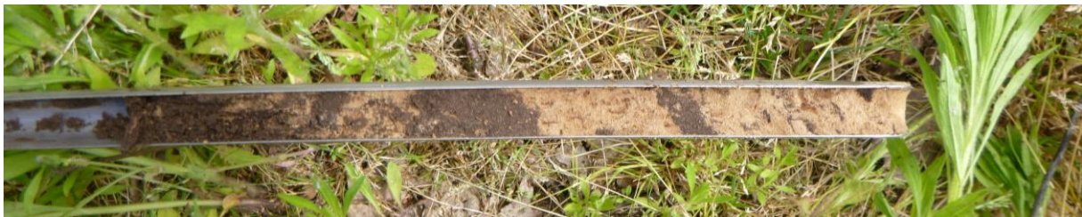
Figuur 20: Foto van de menglaag zoals deze op boorpunt 3 is aangetroffen.
