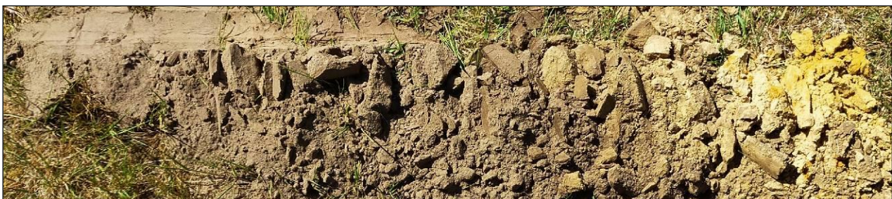
Figuur 7: Het boorprofiel van boring 6. De leesrichting is van links naar rechts (0-110 cm -mv)(kleuren zijn afwijkend door het felle zonlicht).
