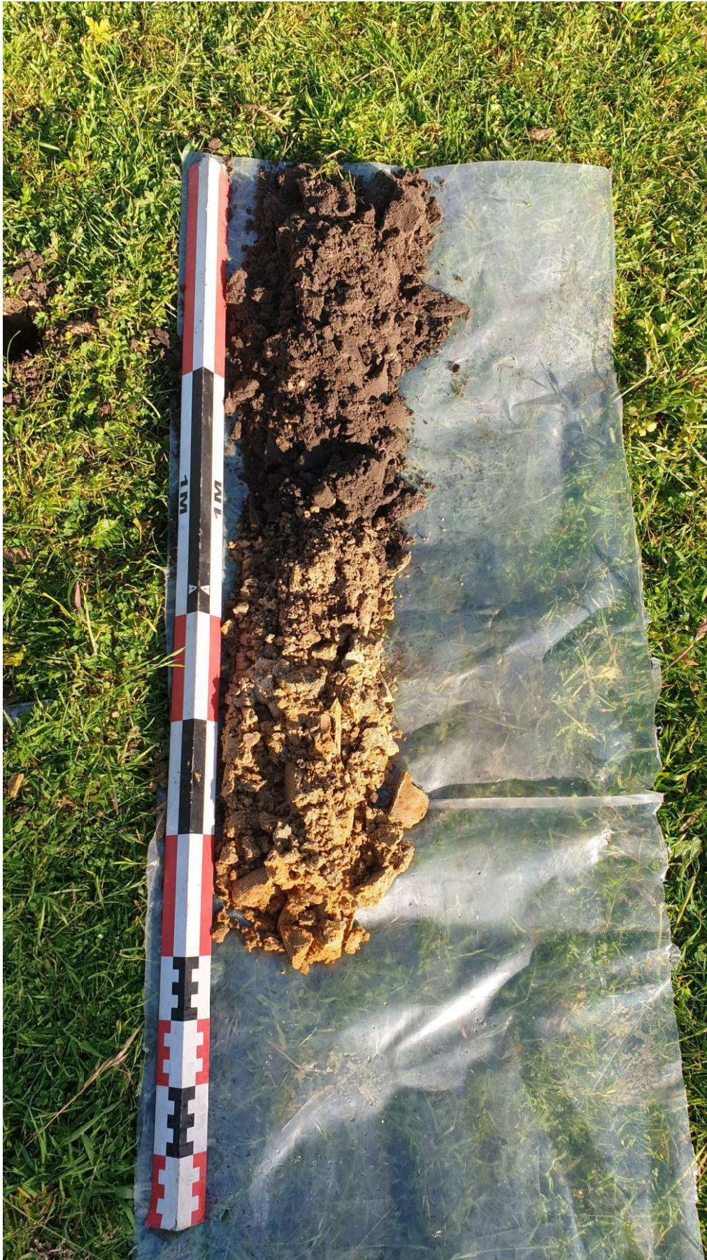
Figuur 1. Foto van het resultaat van de boring op boorpunt 1.
