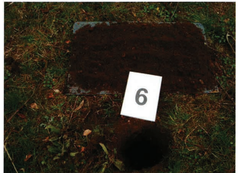
Foto 6: uitgekomen materiaal inspectiegat 6
