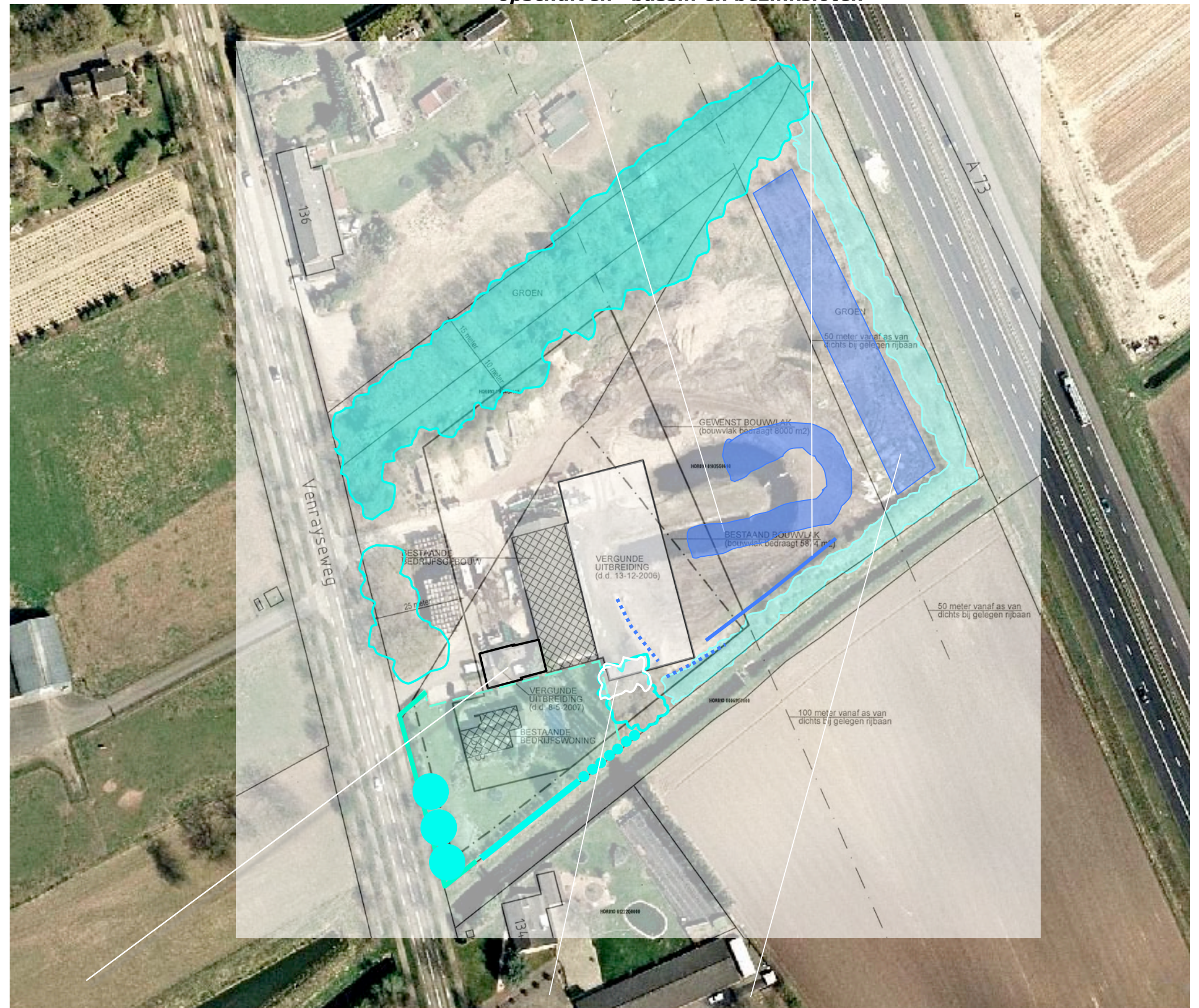
slopen aanwezige berging tbv bouwplan te rooien bomen infiltratiezone
