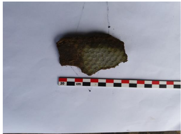
Foto 10 – asbestverdacht plaatmateriaal op maaiveld ter plaatsse van boring 12
