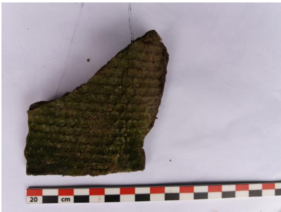
Foto 9 – asbestverdacht plaatmateriaal op maaiveld ter plaatsse van boring 1
