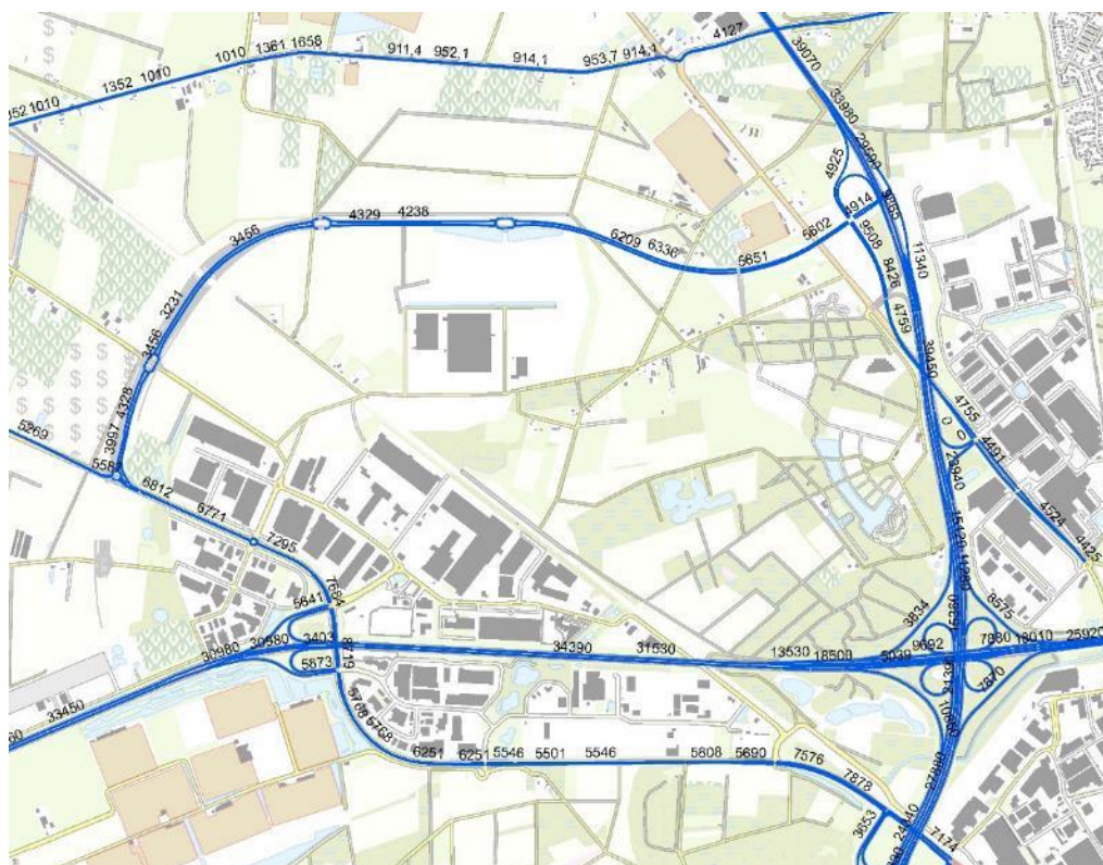
Figuur 17: Verkeerscijfers autonoom (etmaalintensiteiten)
