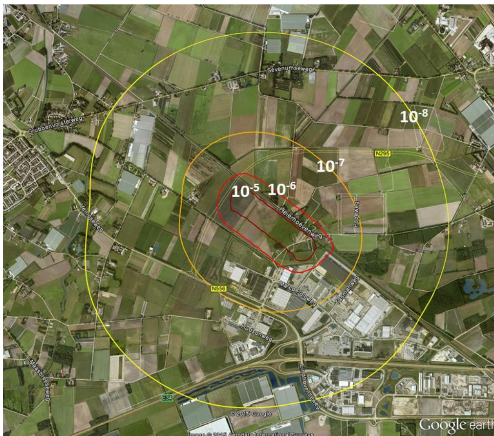
Figuur 52: Risicocontouren railterminal o.b.v. SAVE 2011, aan Arcadis verstrekt door Antea in december 2015
