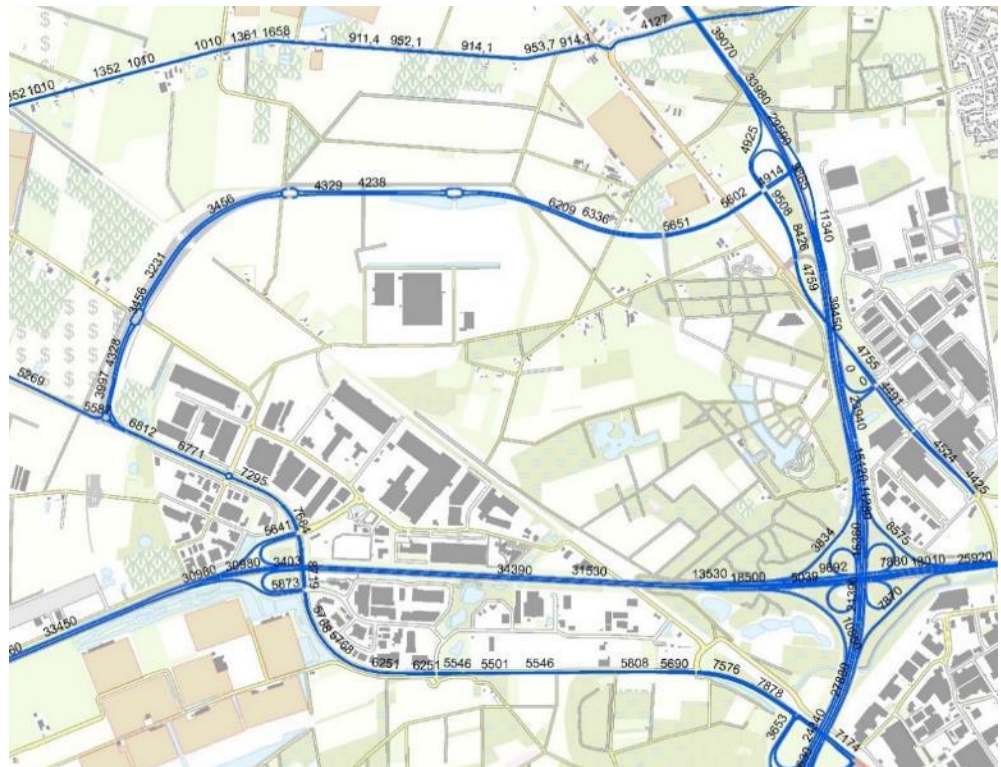
Figuur 37 Verkeerscijfers autonoom (etmaalintensiteiten)
