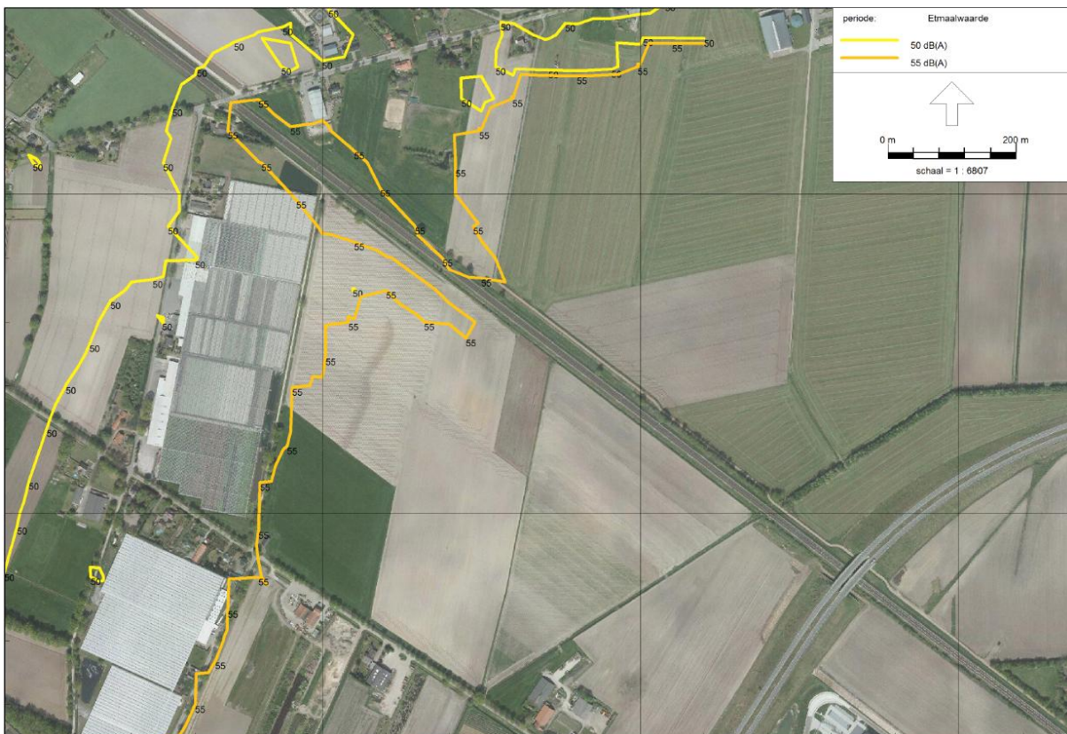
Figuur 6: 50 en 55 dB(A) L etmaal -contouren conform de Nota Industrielawaai met aanpassing van Klaver 5, fase 1
