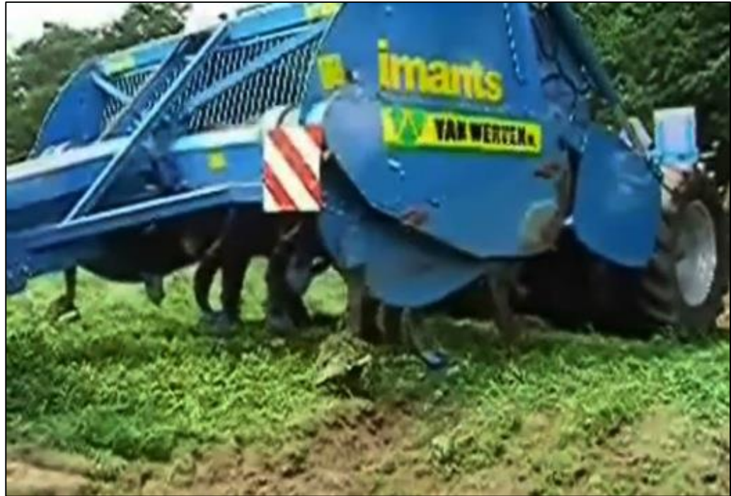
Afbeelding 26: Diepspitten. Bron: https://www.youtube.com/watch?v=PJFJoinriLg
