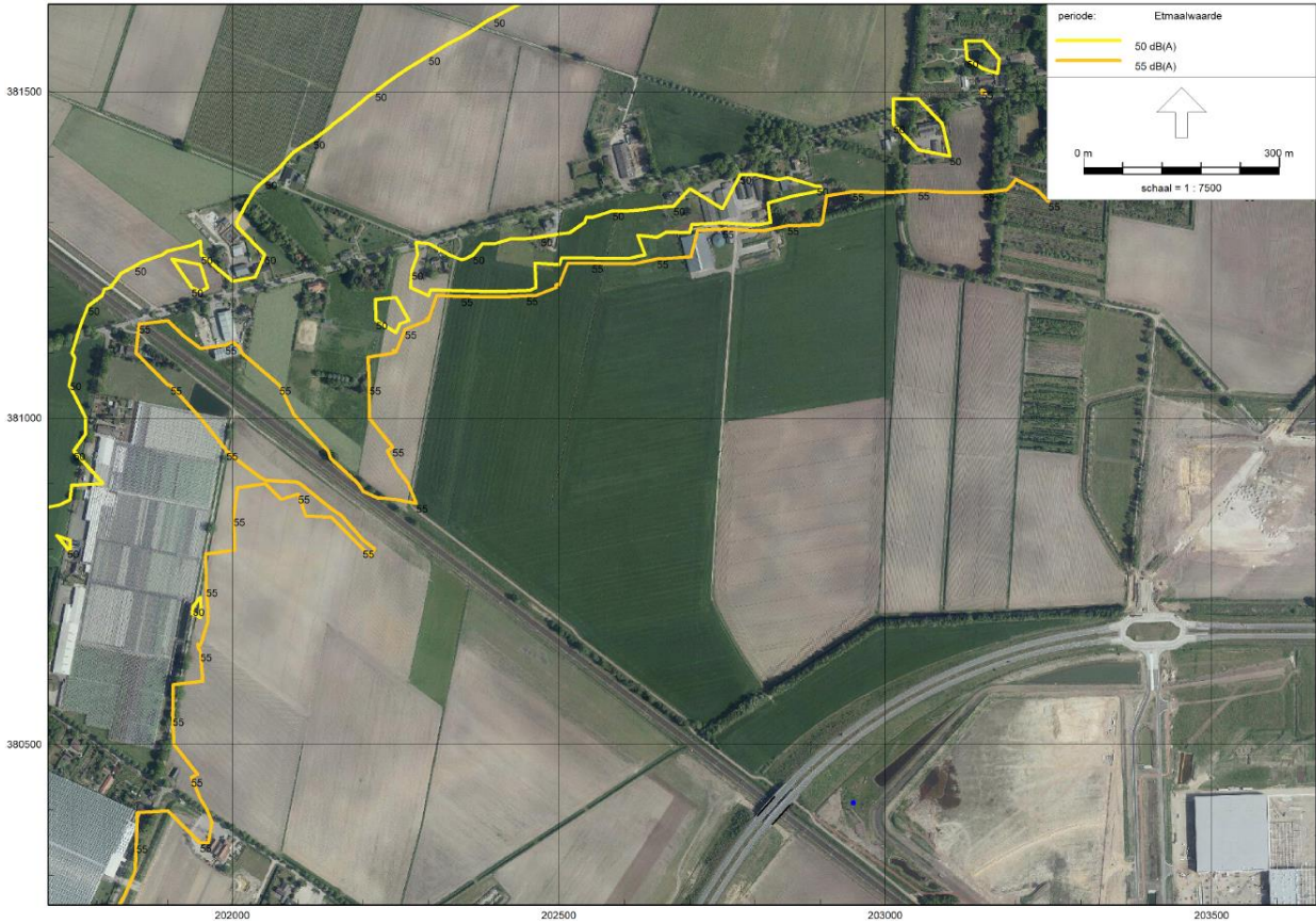
Figuur 10-1 50 en 55 dB(A) Letmaal-contouren conform de Nota Industrielawaai
