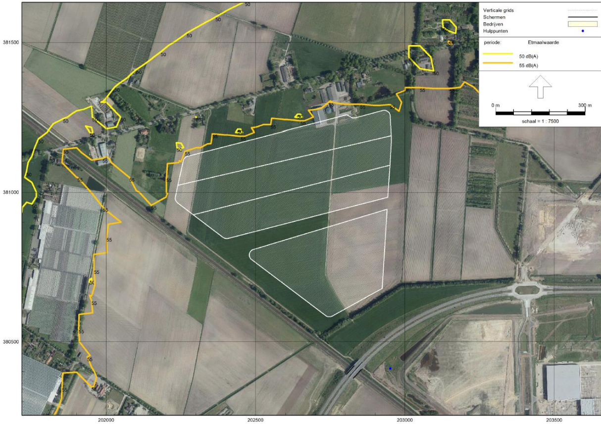
Figuur 10-4 50 en 55 dB(A) Letmaal-contouren conform de Nota Industrielawaai met aanpassing van Klaver 3
