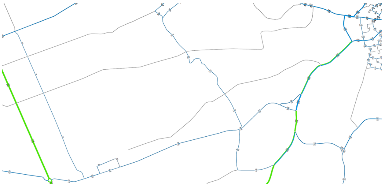
Figuur 37a Uitsnede regionaal verkeersmodel, Verkeersintensiteiten te westen van Sevenum, omgeving Toverland, (bron Verkeersmodel Noord Limburg 2014, RMO Noord-Limburg/Royal Haskoning DHV, prognose jaar 2030)
