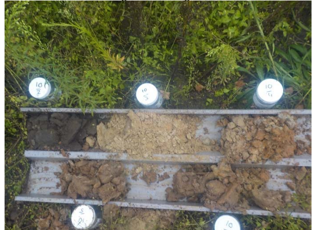
Foto 12 Profiel ondergrond boring 10
