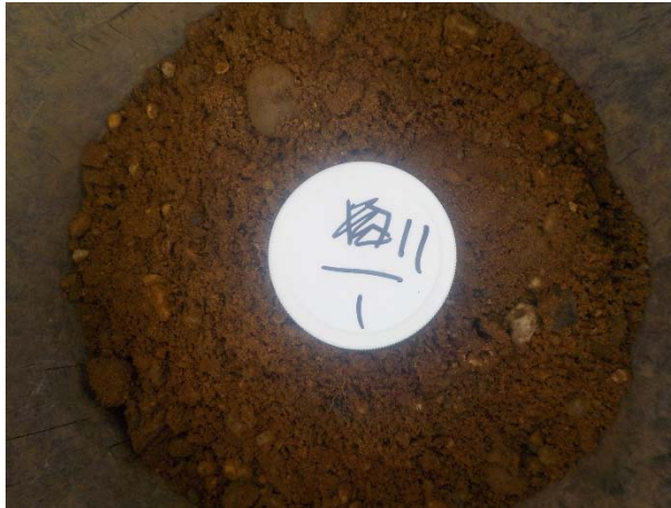
Foto 9 Profiel bovengrond boring 11
