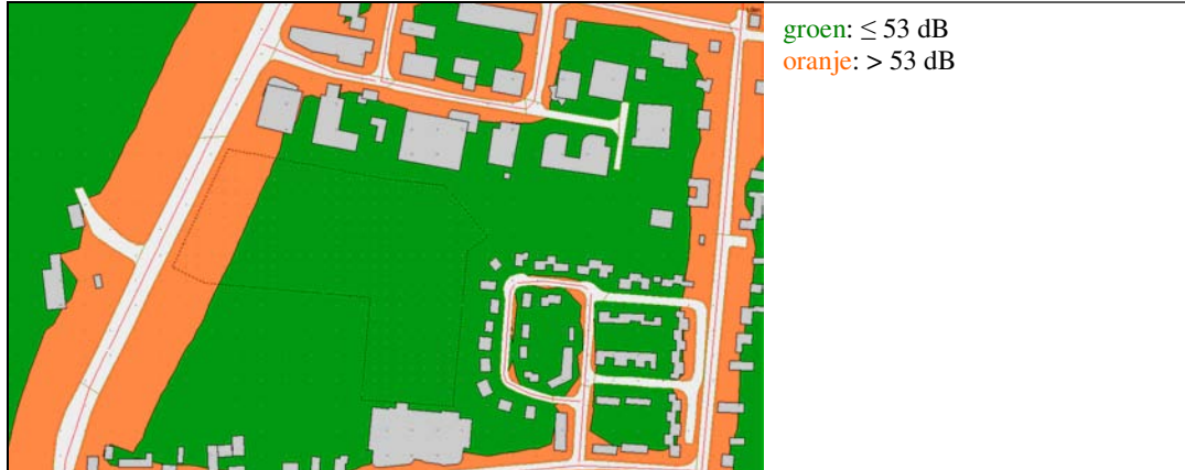
figuur 8: resultaten voor alle wegen samen ( L_{den} [dB], excl. correctie art.110g Wgh)
