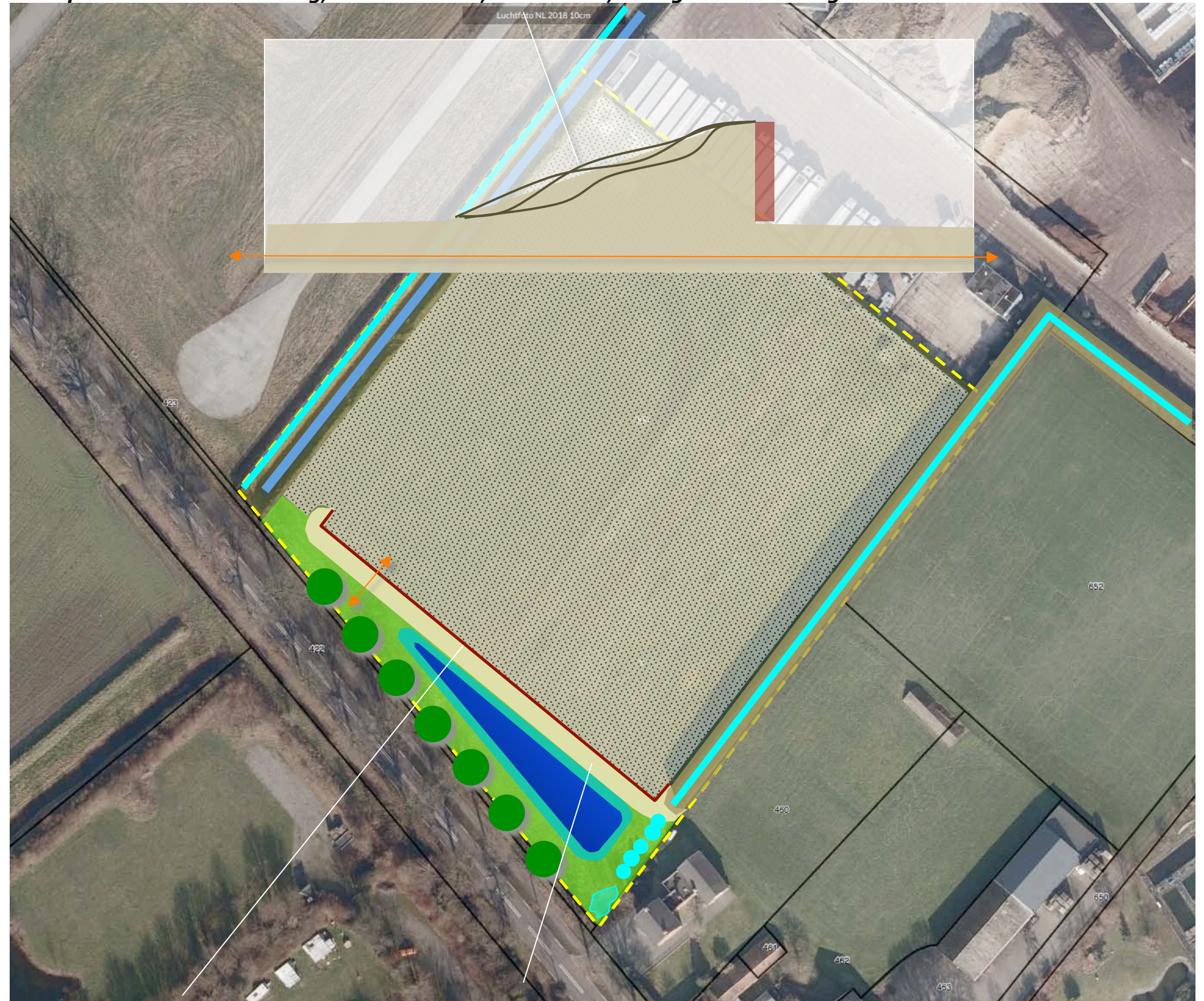
stapelblokkenbeton, 3 lagen, 240 cm hoog, aanaarden; golvend talud met een wisselende hellingshoek
