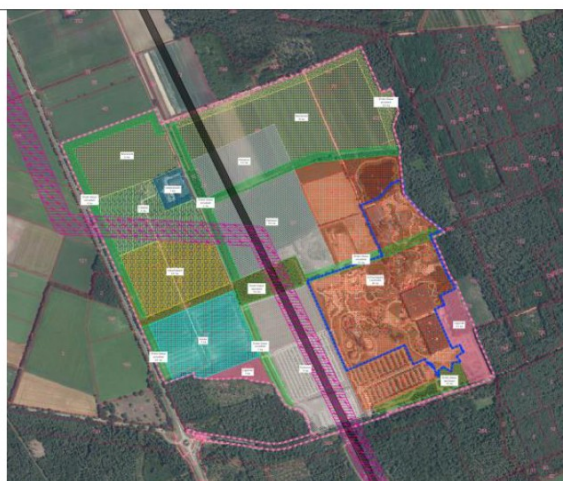
Model 3B: Verdicht parkconcept met uitbreiding richting het noorden, de verblijfsfunctie aan de westzijde, een grondwal aan de noordzijde en een groenafscherming aan de westzijde.
