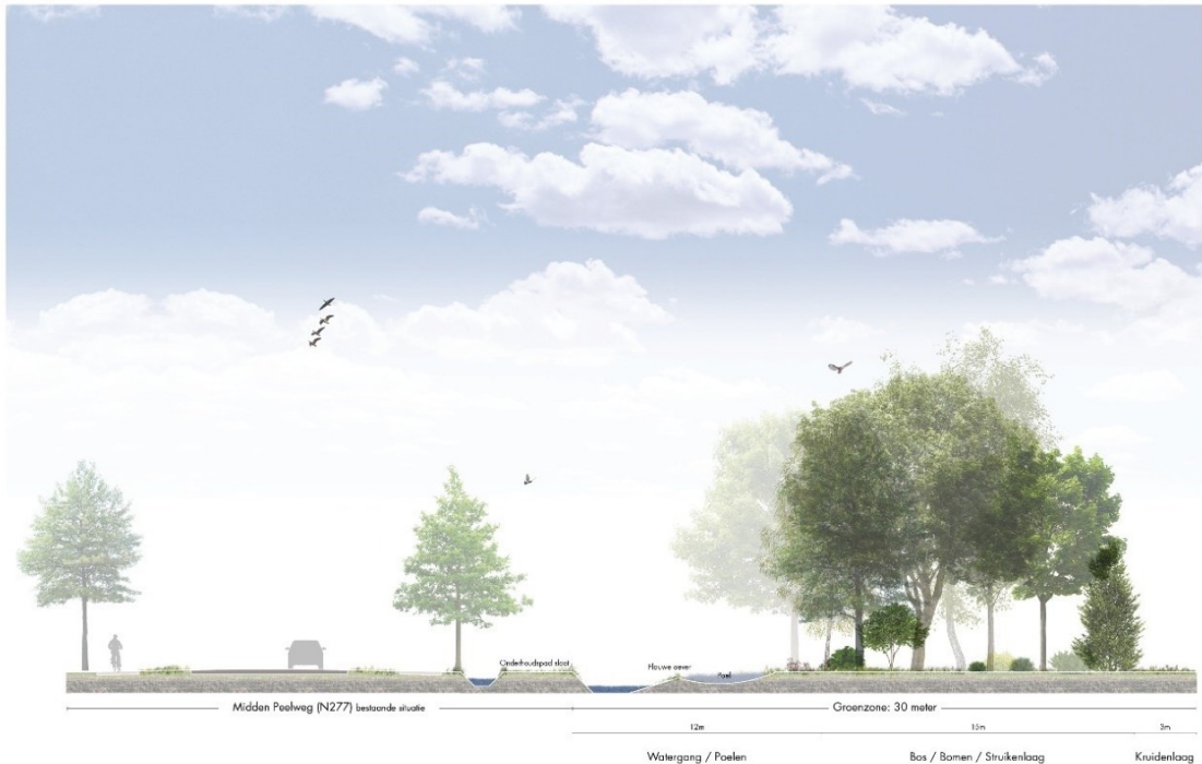
Afbeelding 28 Principedoorsnede Midden Peelweg, met wadi/bergingsfunctie in de groenstrook gecombineerd met het nieuwe tracé Wertemer/Steegbergheide met 5 m schouwpad/onderhoudstrook
