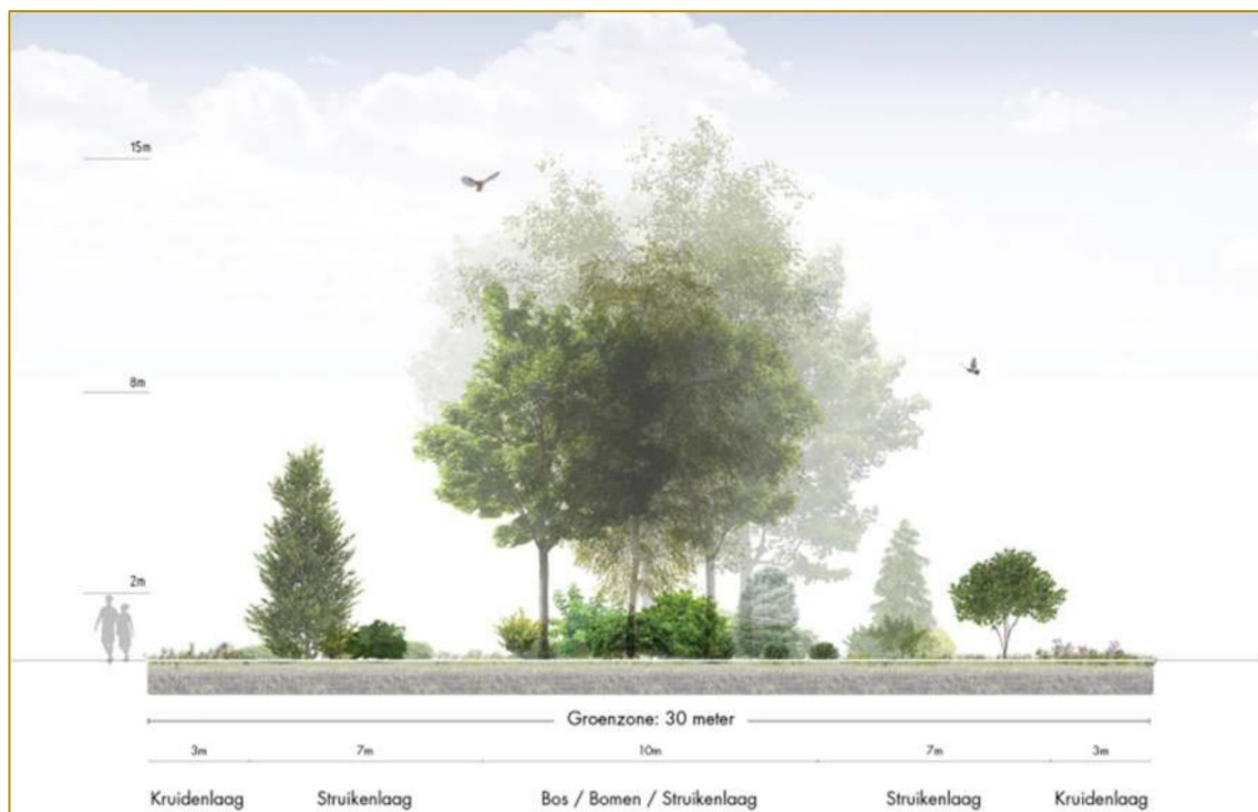
Principedoorsnede groenzones/corridors binnen de toekomstige ontwikkeling
