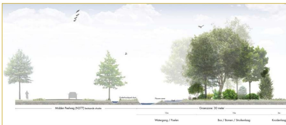
Principedoorsnede Midden Peelweg, met wadi/bergingsfunctie in de groenstrook
