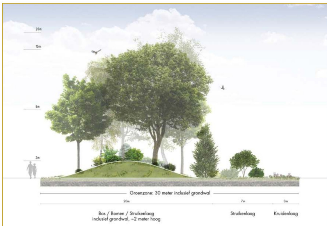
Principedoorsnede noordelijke randzone inclusief te beplanten grondwal
