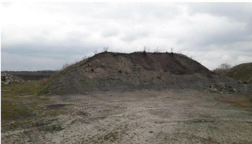
Foto 108: Depot freesafalt vermengd met zand (afkomstig van tijdelijke verharding in verband met bouwwerkzaamheden op het terrein van Toverland)
