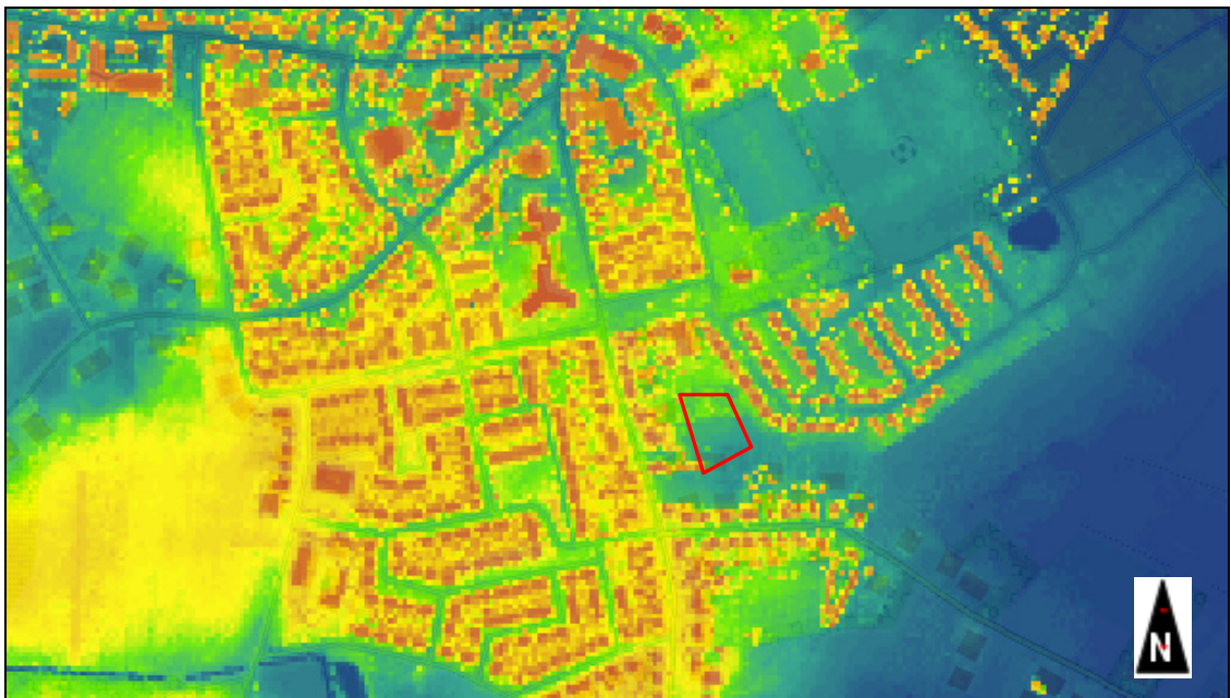
Figuur 2.1 De ligging van het plangebied Maasbreeseweg te Sevenum op het Actueel Hoogtenbestand van Nederland (AHN 2009). Het plangebied is globaal weergegeven met een rode kader. Duidelijk blijkt dat Sevenum en het plangebied op een hoge dekzandrug (geel tot lichtblauw) liggen. De zone met gele kleur heeft een hoogte van 28,92 m + NAP. De lichtblauwe zone is de glooiing (27,87 m) naar het diepe beekdal (25,87 m +NAP). Binnen het plangebied heeft de lichtgroene zone een hoogte van 28,45 m +NAP.
